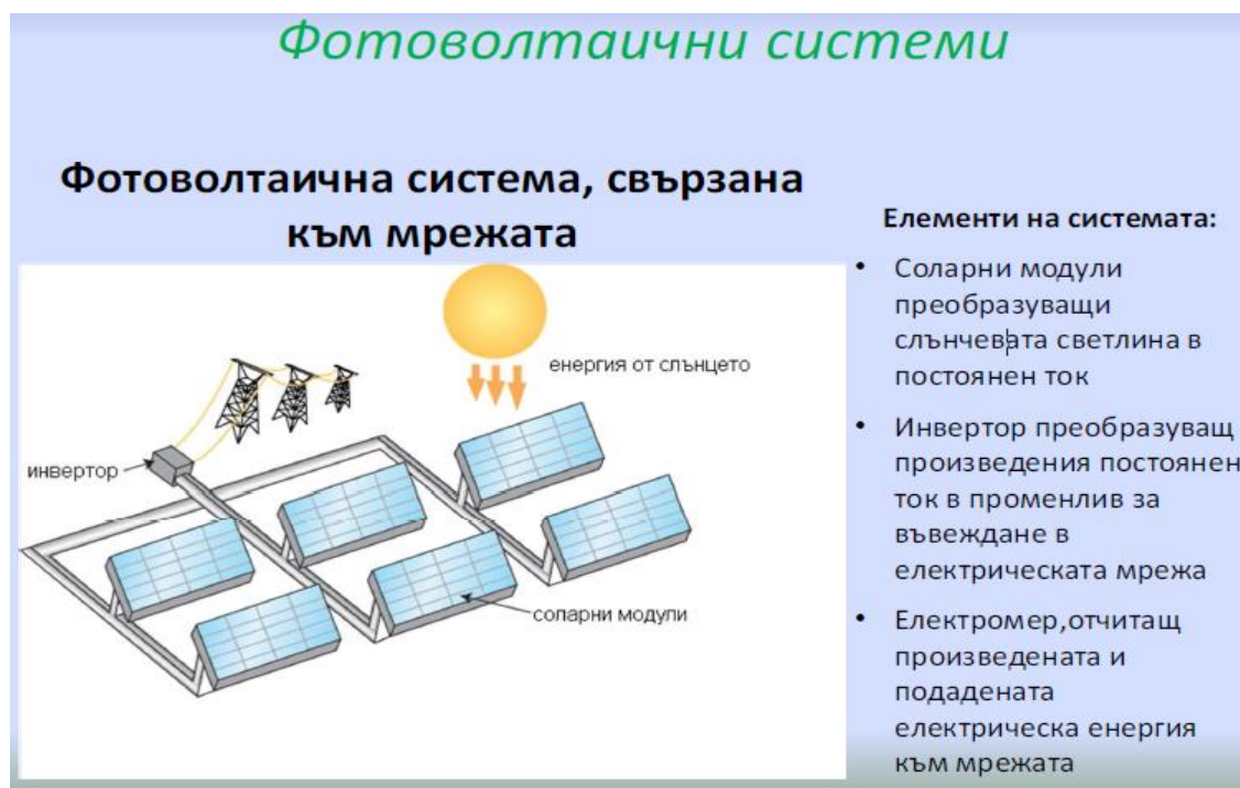
Фиг. 4 Фотоволтаична система свързана към мрежата
